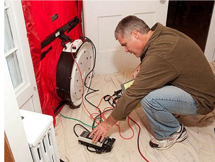
Blower door air leakage test
